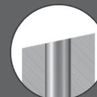
Врезание в наклонную поверхность
